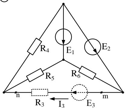
1. Найти параметры эквивалентного генератора ( $E_\Theta$ ,  $R_\Theta$ ), заменяющего активный двухполюсник с зажимами n, m
