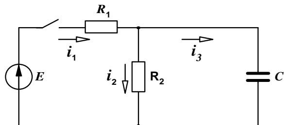
$$E=140 \text{ В}, R_1=20 \text{ Ом}, R_2=50 \text{ Ом}, C=1000 \text{ мкФ}.$$
