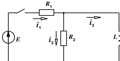
$$E=200 \text{ В}, R_1=40 \text{ Ом}, R_2=60 \text{ Ом}, L=120 \text{ мГн}.$$
